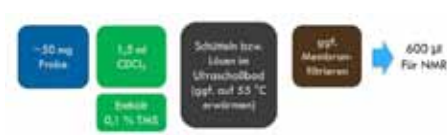
Abb. 7: Probenaufarbeitung von Mineralöl-Rohstoffen für die ^1\text{H} -qNMR
