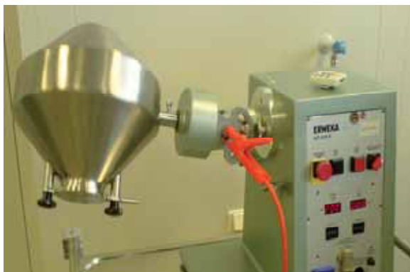
Doppelkonusmischer Foto: Hochschule Sigmaringen (Silvia Panter)
