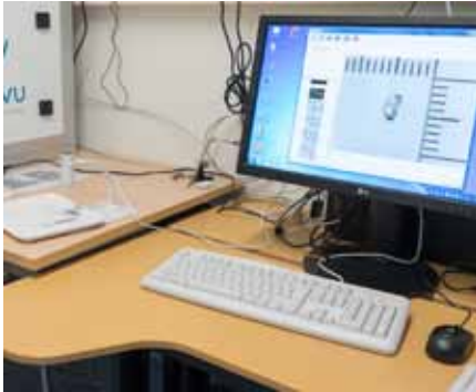
Abb. 1: Aufbau des Systems bestehend aus Digitalmikroskop, Messskala aufgelegt auf zu messendes Objekt und Computersystem zur Dokumentation
