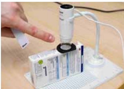
Abb. 2: Vergrößerte Darstellung des Mikroskops. Die Messskala wird auf der zu bestimmenden Verpackung auf ein kleines x in einem Kennzeichnungselement ausgerichtet
