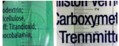
Abb. 3: Beispiele für Mikroskopaufnahmen von Verpackungen. In den vorliegenden Fällen entspricht die Schriftgröße den geforderten 1,2 mm.
