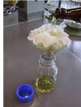
Abb. 1: Probenvorbereitung: Filtration von Bierproben.
